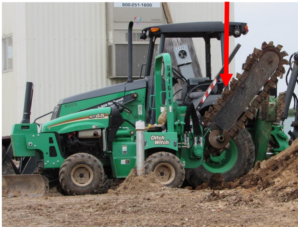
Equipo de construcción común como el "ditch witch" plantea serios riesgos de quedar atrapado.
