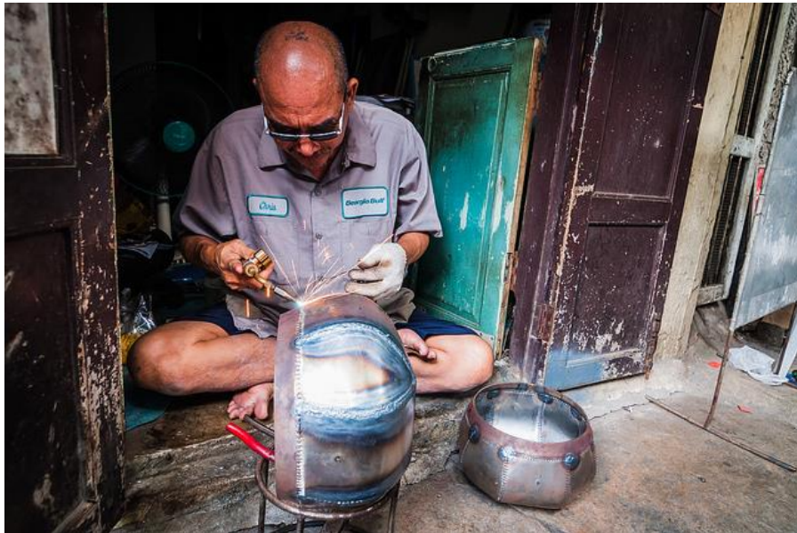
El individuo no está usando la protección de cara y ojos adecuada para los riesgos en ésta foto. (*2)
