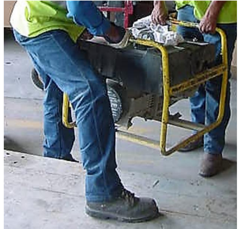
Trabajadores levantando un generador mientras usan botas con punta de acero.
