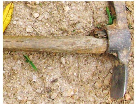
Una manija agrietada y reparaciones caseras hacen que esta herramienta sea un riesgo y debe ser eliminada del servicio. (*5)
