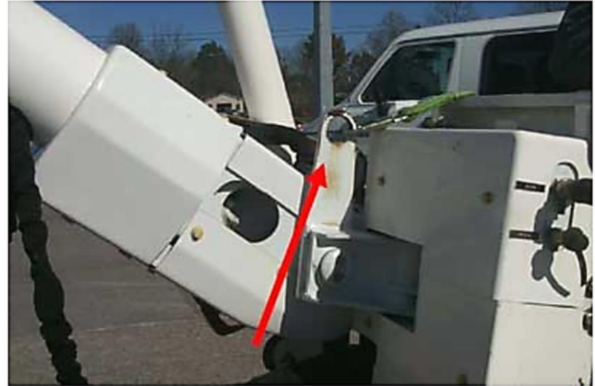
La fotografía muestra el montaje del brazo a la canasta y el gancho de ojo para montar el arnés.
