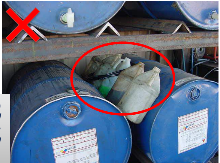
Ejemplos de contenedores sin etiqueta guardados incorrectamente.
