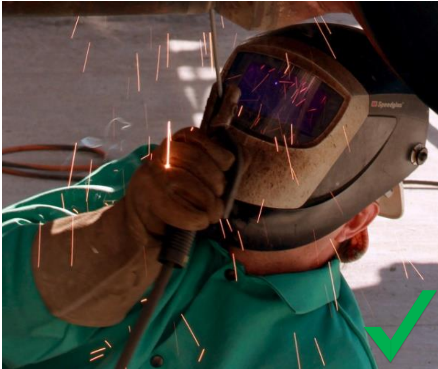
Trabajador soldando apropiadamente con equipo para proteger ojos/cara. (*4)
