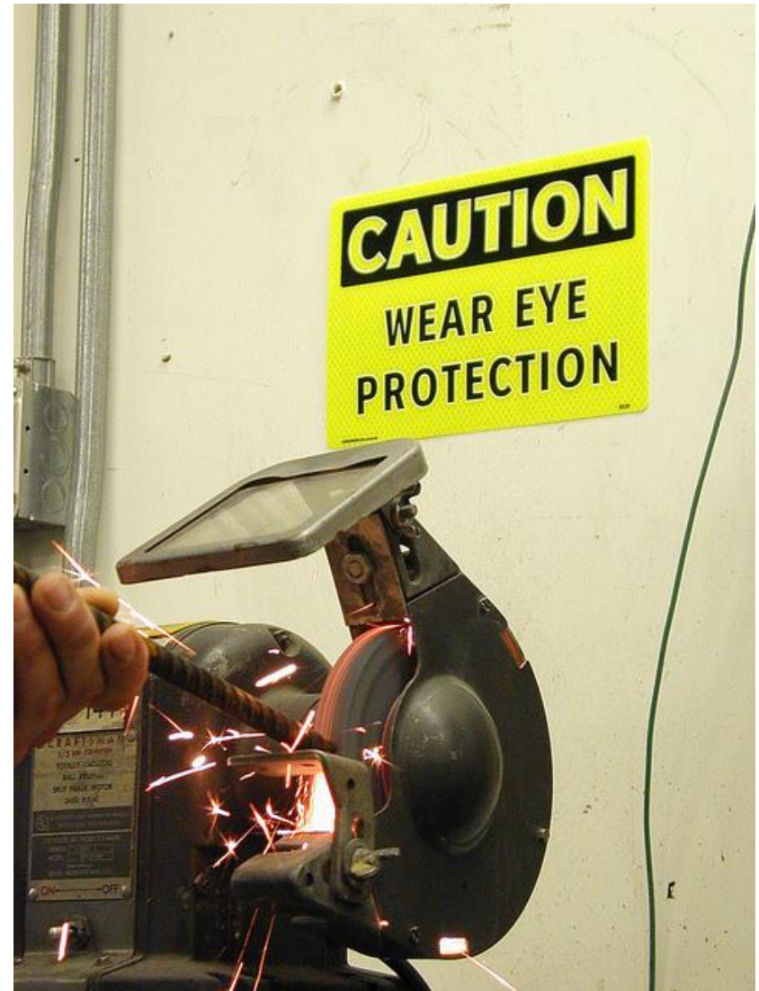
Los riesgos de impacto pueden ser creados por herramientas de trituración o cortes como el banco triturador que aparece arriba. (*3)
