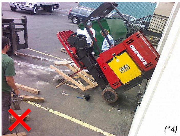
Montacargas industrial comúnmente usado en almacenes. Este montacargas fue llevado a la orilla del muelle. Afortunadamente, no se reportaron lesiones.
