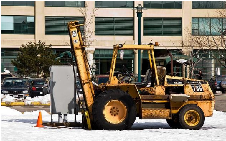
Arriba: Montacargas para terrenos irregulares (*3); Debajo: Montacargas telescópico o de auge. (*4)
