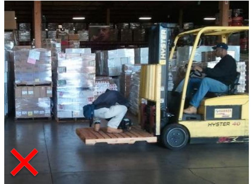
Hombre montado ilegalmente en un pallet del montacargas. (*10)
