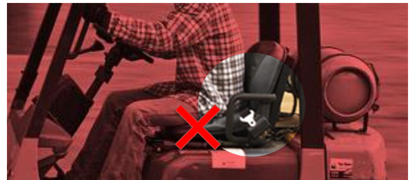
Hombre utilizando el montacargas sin utilizar cinturón de seguridad. (*12)
