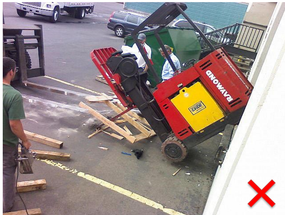
Montacargas industrial comúnmente usado en almacenes. Este montacargas fue llevado a la orilla del muelle. Afortunadamente, no se reportaron lesiones. (*5)
