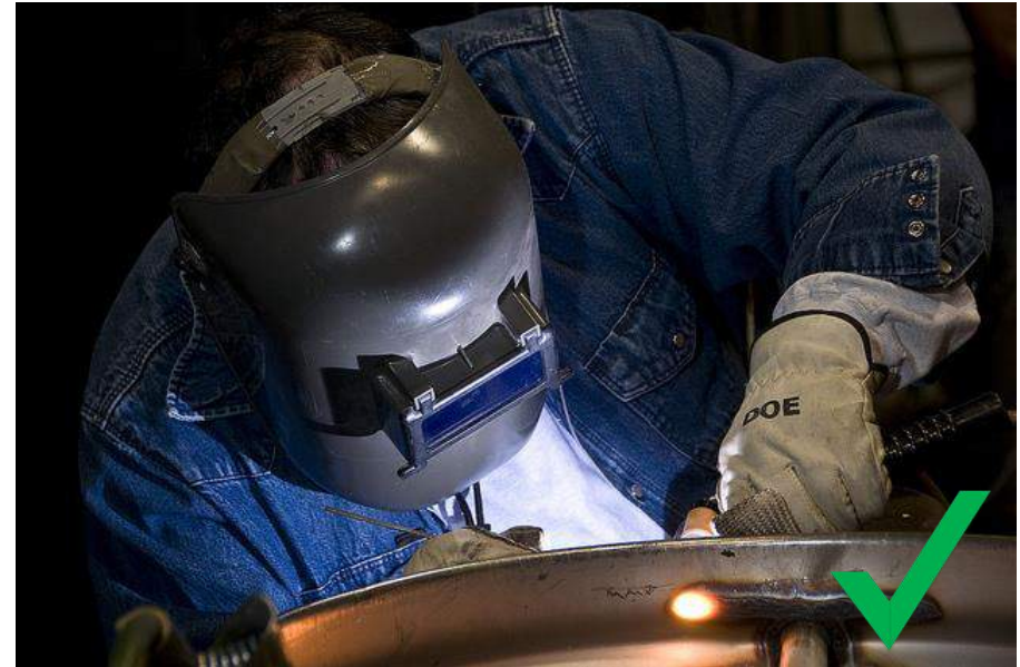
Parece que este trabajador está usando el equipo protector adecuado. (*3)
