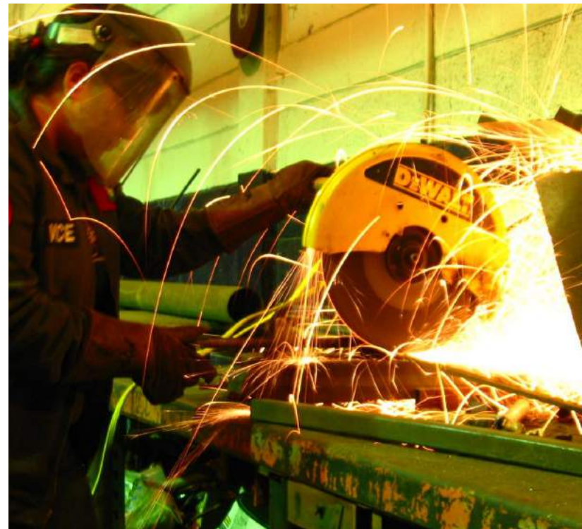
Trabajador usando protección de ojos y protector facial para la actividad de soldado/corte. (*1)
