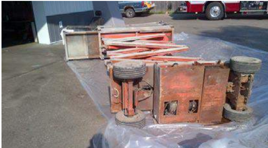
Imágenes de la investigación de una fatalidad donde un pintor murió cuando su elevador de tijera se volcó y cayó después de que lo movió a un drenaje de lluvia. Reporte de Investigación MIFACE: #13MI091 (*4)
