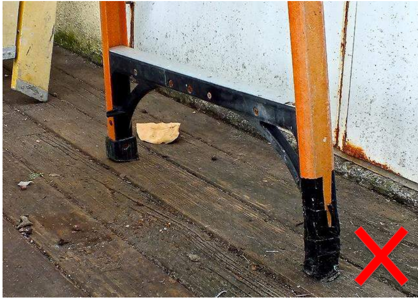
Pie dañado en una escalera de peldaños con un trabajo inapropiado de reparación usando cinta. (*3)
