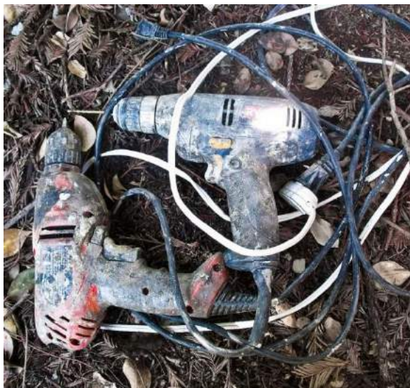
Estos taladros están cubiertos de pintura y suciedad que podría esconder grietas o defectos peligrosos. (*5)
