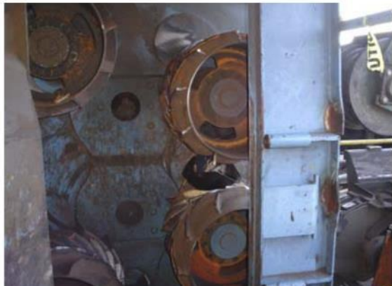
Foto 3. Esta foto ilustra los rodillos de alimentación de la descortezadora sur donde la víctima había estado soldando metal a los dientes de la descortezadora. (*6)
