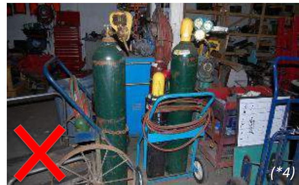
Los tanques de acetileno y oxígeno no deben ser almacenados juntos.
