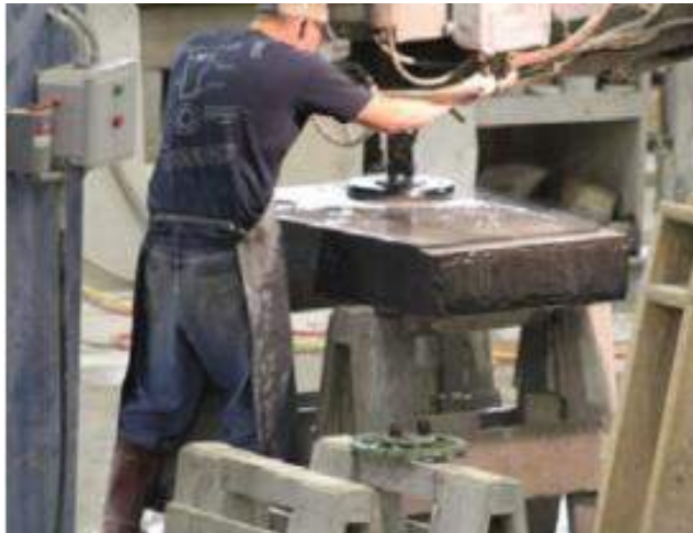
Un trabajador usa una trituradora de piedra que aplica agua en la superficie del trabajo para reducir el polvo de sílice. (*4)
