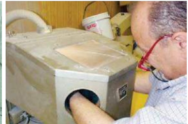
Un trabajador usa un recinto que aísla el polvo de sílice mientras usa explosiones abrasivas para moldes dentales. (*6)
