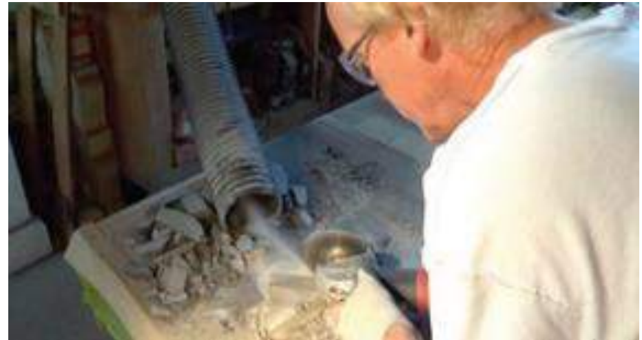
Al moler la piedra, un trabajador usa una ventilación por extracción que retira el polvo de sílice para reducir exposición. (*7)
